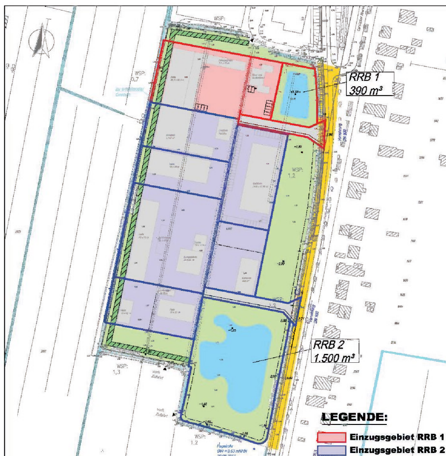
Abbildung 3: Einzugsgebiete der Regenrückhaltebecken
